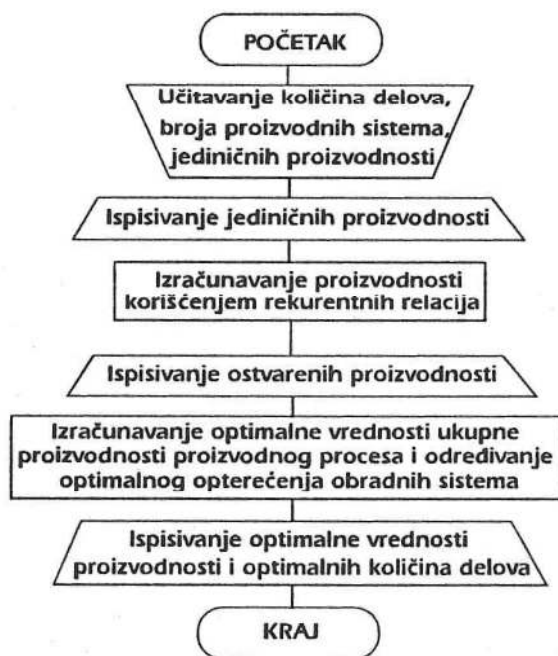
Slika 1. Etape izbora optimalnog rešenja primenom dinamičkog programiranja
